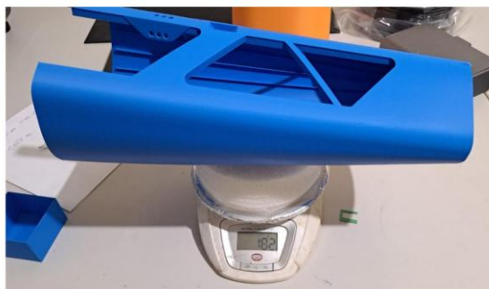
Figure 6 - Test 3D printa krmenne sekcije Parabelluma
