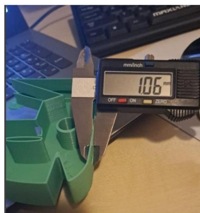
Figure 4 - Verifikacija kalibriranja 3D printera
