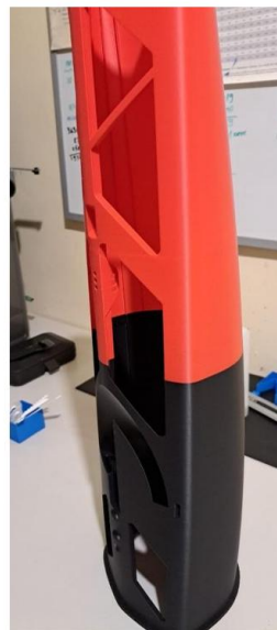
Figure 8 - Test preciznosti (tolerancije) spoja centralne i krmene sekcije
