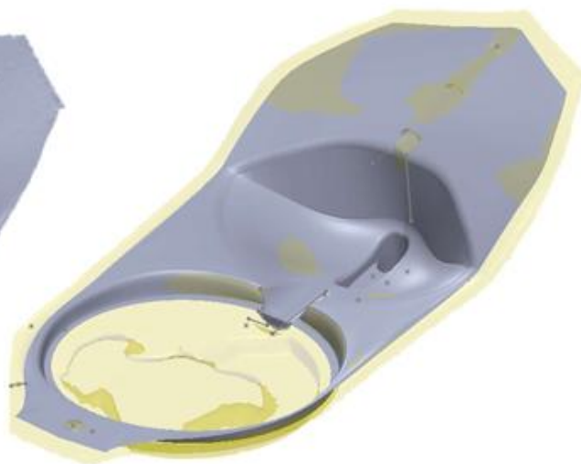
Slika 2 CAD model napravljen po uzoru na skeniranu palubu
