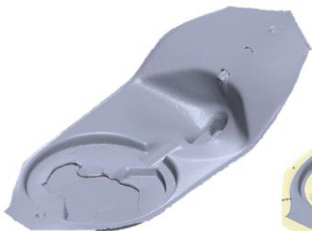
Slika 1 Sken laminirane palube
