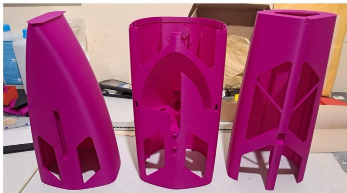
Figure 9 - Konačne odabrane printane sekcije trupa Parabelluma
